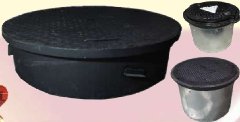
Manhole. Fabricados en acero modular, son utilizados para cubrir las entradas del pozo de monitoreo, la boca de medida y el acceso al tanque de almacenamiento donde se instala la bomba sumergible. Disponibles de 8", 12" y 38" de diámetro.
