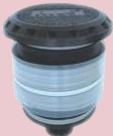
Spill Containment. Contenedor de derrames de 5 galones con válvula de retorno al tanque, utilizado en la boca de llenado de combustible, brindando seguridad al momento de la descarga.
