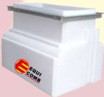
Cajas contenedoras de derrame para dispensadores y bombas Cajas en polietileno virgen de alta densidad instaladas debajo de los surtidores y sobre los tanques de almacenamiento para evitar derrames de combustible. Las cajas contenedoras para dispensadores están disponibles en 3 tamaños para dispensadores de 1, 2 o 3 productos.
